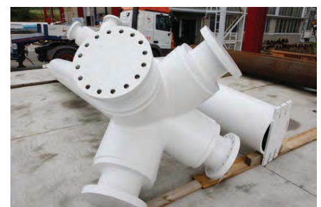
Bild 15: Knoten mit werkseitiger Grundierung © Vollack Bautechnik GmbH & Co. KG
