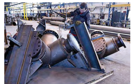
Bild 13: Schablone zur Knotenfertigung © Vollack Bautechnik GmbH & Co. KG
