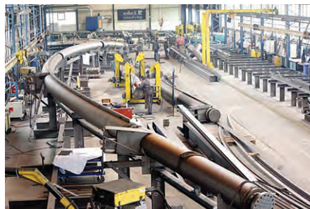
Bild 12: Leegerüst der Längswandbinder © Vollack Bautechnik GmbH & Co. KG
