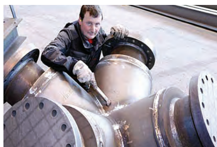
Bild 14: Knoten aus fünf Rohrteilen © Vollack Bautechnik GmbH & Co. KG
